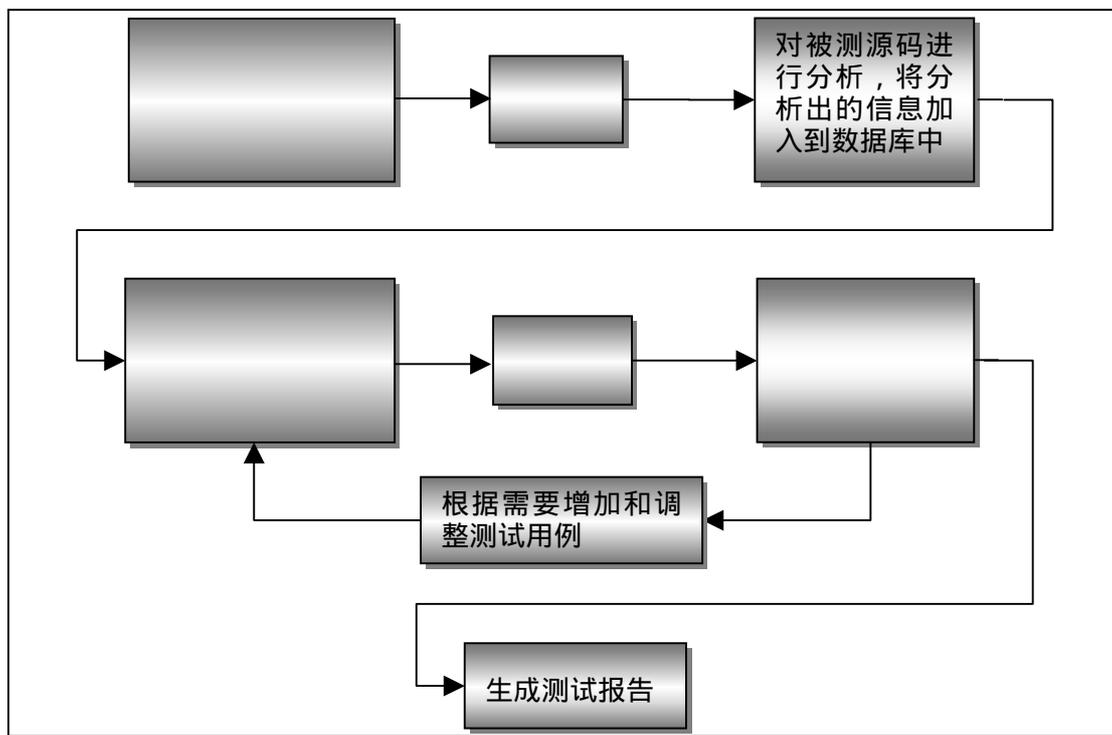
图3 嵌入式软件测试系统测试流程
