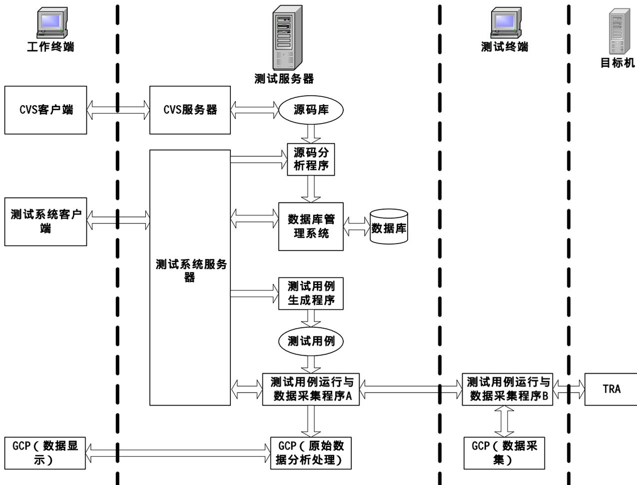
图2 嵌入式软件测试系统基本结构
